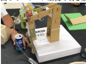
図15 水圧シリンジを利用した機構
