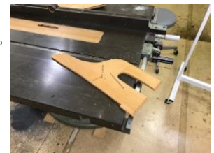
図2 丸鋸昇降盤を使うための取っ手
